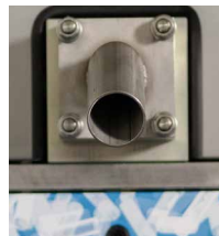
Rutsche leicht über 4 Schrauben abnehmbar
